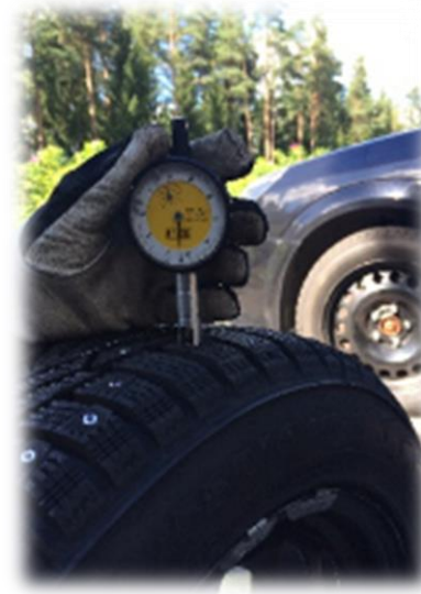
Kuva 57: Nastaulkoneman mittaus testien yhteydessä. (kuva: Roosa Ritola)
