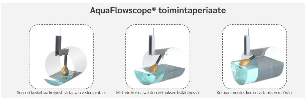
Kuva 4 AquaFlowscopen pintamittauksen periaate
