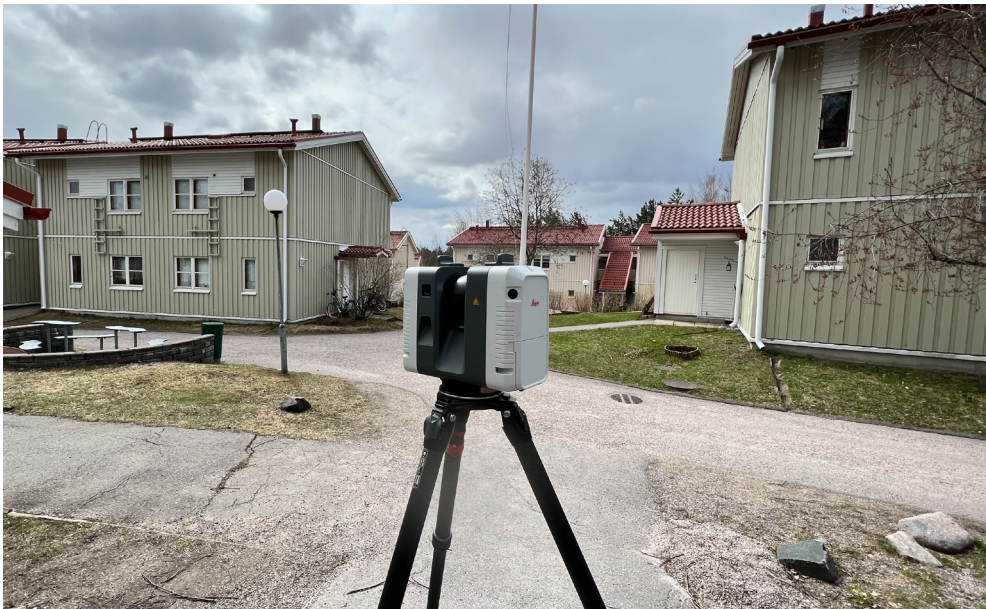
Kuva 4. Leica RTC360 maalaserkeilain mittaamassa Latokasken kohdetta.
