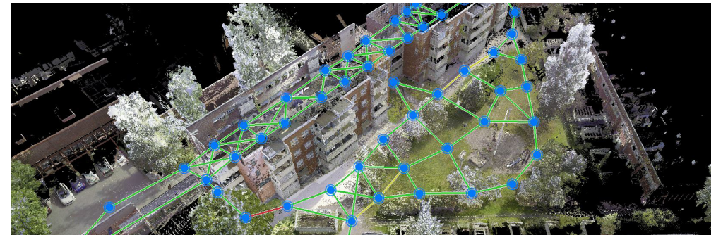
Kuva 5. Hankkeessa toteutetun maalaserkeilauksen yhdistetty pistepilvi keilainasemien Malminkartanon kohteesta.
