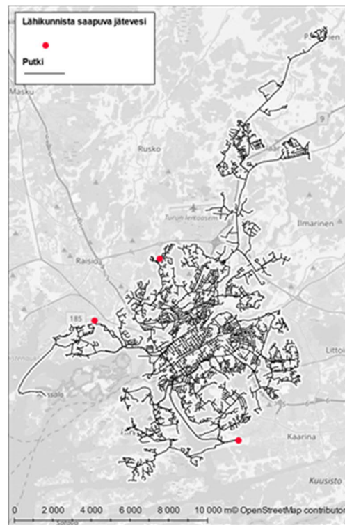
Kuva 34. Turun viemäriverkoston mallin runkoputkistoa, mallin kattaman alueen asukasmäärä on 285876. Ulkopuolisten, vakiolämpötilaisten, malliin liittyvien virtaamien kohdat merkitty punaisella pisteellä (kuva: Fluidit Oy).
