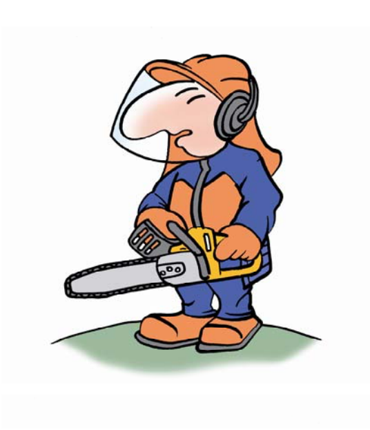
Kuva 9. Moottorisahan käyttäjän turvavarusteita ovat kypärä, jossa kuulosuojaimet ja silmäsuoja, teräsvahvisteiset turvajalkineet, kuituvahvisteinen työpuku, jonka valmistusmateriaalin kuidut pysäyttävät teräketjun mahdollisen vahingon sattuesssa, sekä käsineet.
