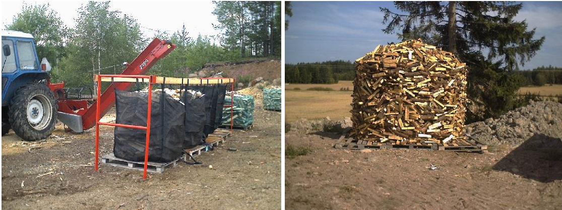
Kuva 15. Pilkkeet on tehty verkkosäkkeihin, joissa ne voi kuivata. Siirtelyyn tarvitaan konevoimaa. Oikella on noin 15 irtokuutiometriä pilkkeitä kuivumassa kuormalavojen päällä verkkokehikon tukemana. Kuvat: Isto Mäkelä
