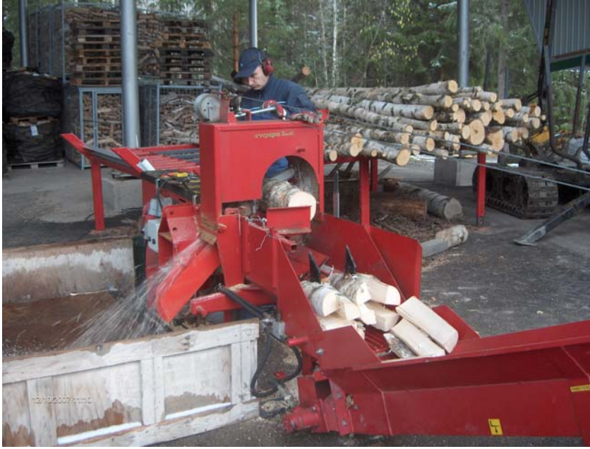
Kuva 14. Sahaava ja halkaiseva pilkekone. Kuva: Ari Erkkilä, VTT
