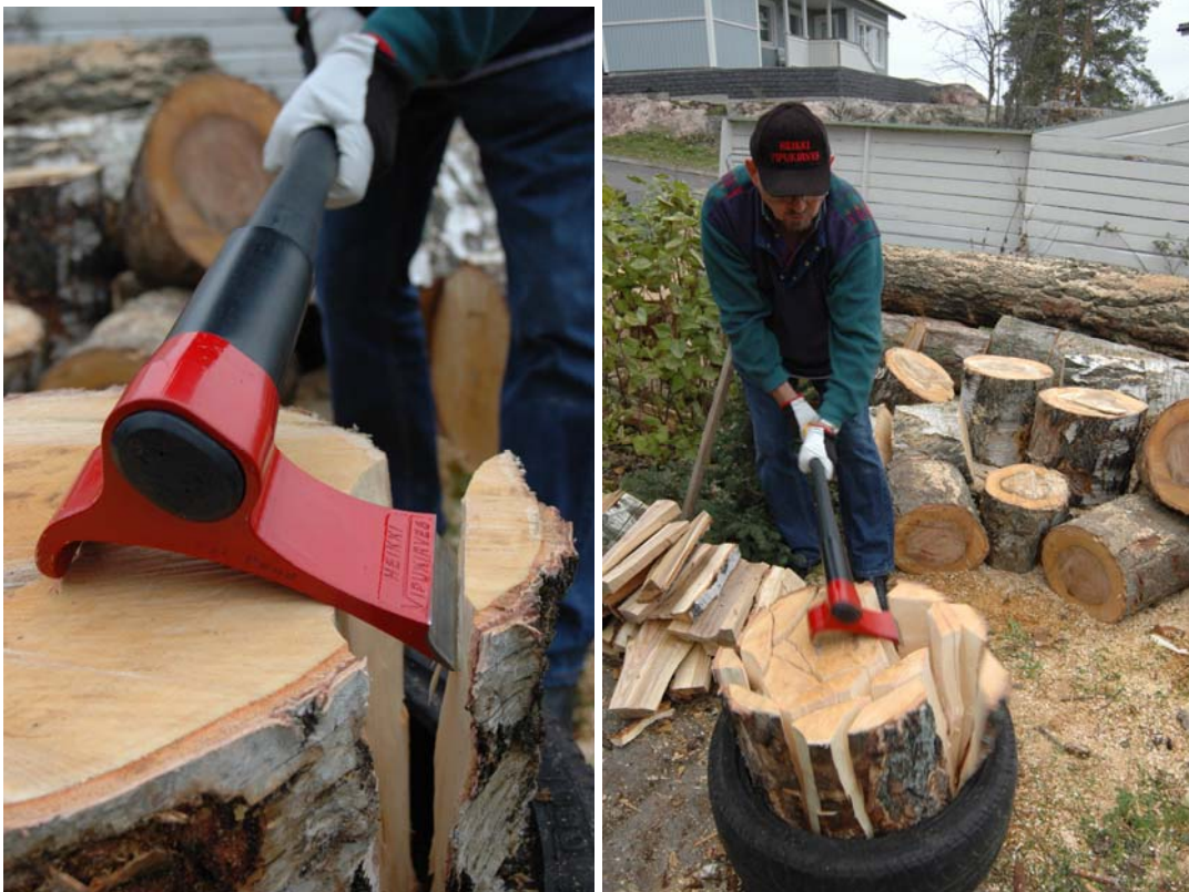
Kuva 12. Vipukirveellä lyötäessä kirveen liike-energia muuttuu vipuavaksi voimaksi, joka vääntää pilkkeen irti pölkystä. Kuva: Vipukirves Heikki Oy
