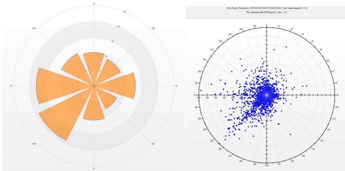
Kuva 7. Tuulensuuntien jakautuminen Pasilan sääasemalla 1.3.–31.10.2019 (asteikko 0–18 %) ja \text{PM}_{10} tuntikeskiarvot Jätkäsaarella eri tuulensuunnilla 1.3.–31.10.2019 (asteikko 0–400 \mu\text{g}/\text{m}^3 ).
