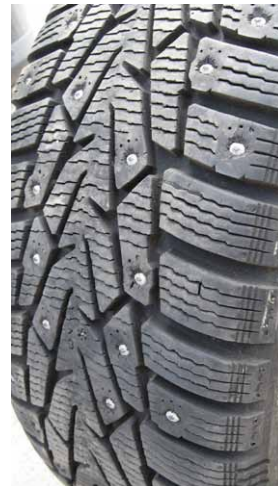
Kuva 12. Kuluneiden renkaiden ja uuden kitkarengaan (Kitka) päästöt suhteessa uuteen nastarengaseen (Nasta). Oikeassa kuvassa kulutettu nastarengas (Nasta(36000): ajettu 36198km), joka aiheutti pienimmät päästöt
