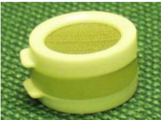
Kuva 1. IVL –tyyppinen NO 2 –passiivikeräin. Kuva 2. Keräimen rakenne.
